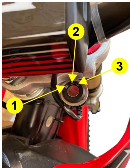
Le contacteur à clé est placé sous le guidon côté droit avec 3 positions "ON" et "OFF"
