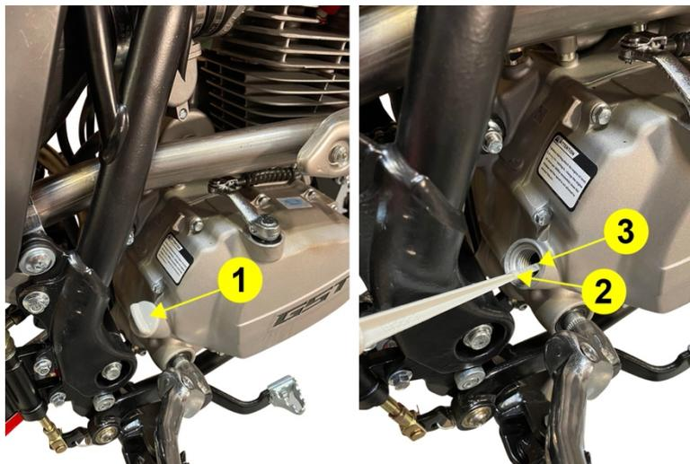
Le niveau d'huile moteur doit être vérifié avant chaque utilisation. Sur ce modèle, vous devez le vérifier grâce à la jauge placée dans le couvercle du carter droit de la moto, comme sur l'image. Voici les étapes à suivre :
